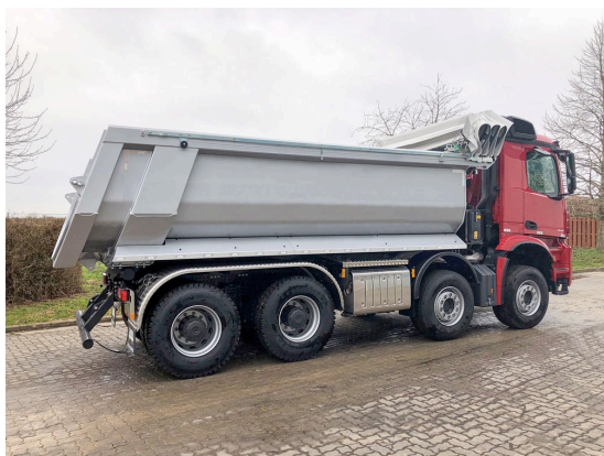
Kippermulde von Carnehl mit TipperRoof von EdschaTS
