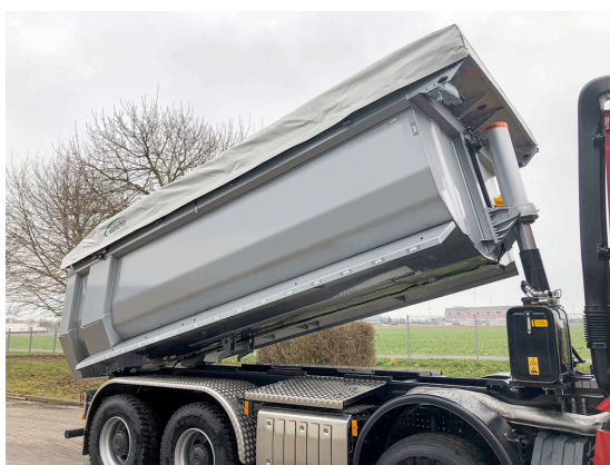
Kippermulde von Carnehl mit TipperRoof von EdschaTS
