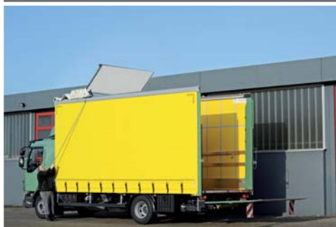
Feststellen des geöffneten Verdecks
