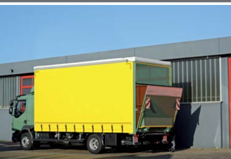
Hydraulisches Öffnen der Ladebordwand
