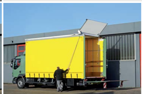
Entriegeln und öffnen des Schieberverdecks
