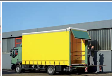
Bedienung und automatisches Aufschwingen des TailWing
